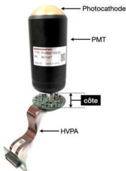
Figure : PMT monté sur une carte HVPA.
