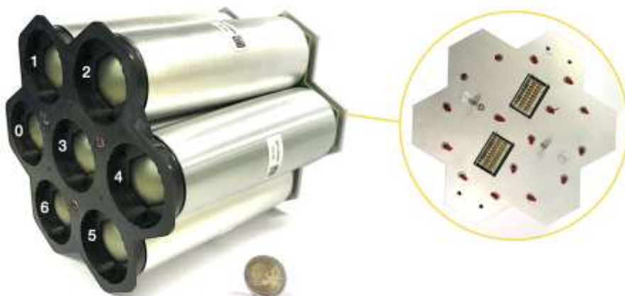
Figure 13: Le FPM assemblé avec le numéro de position des DU
