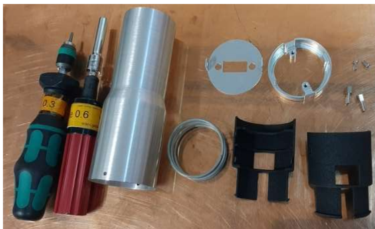
Figure 10: Eléments mécaniques du DU
