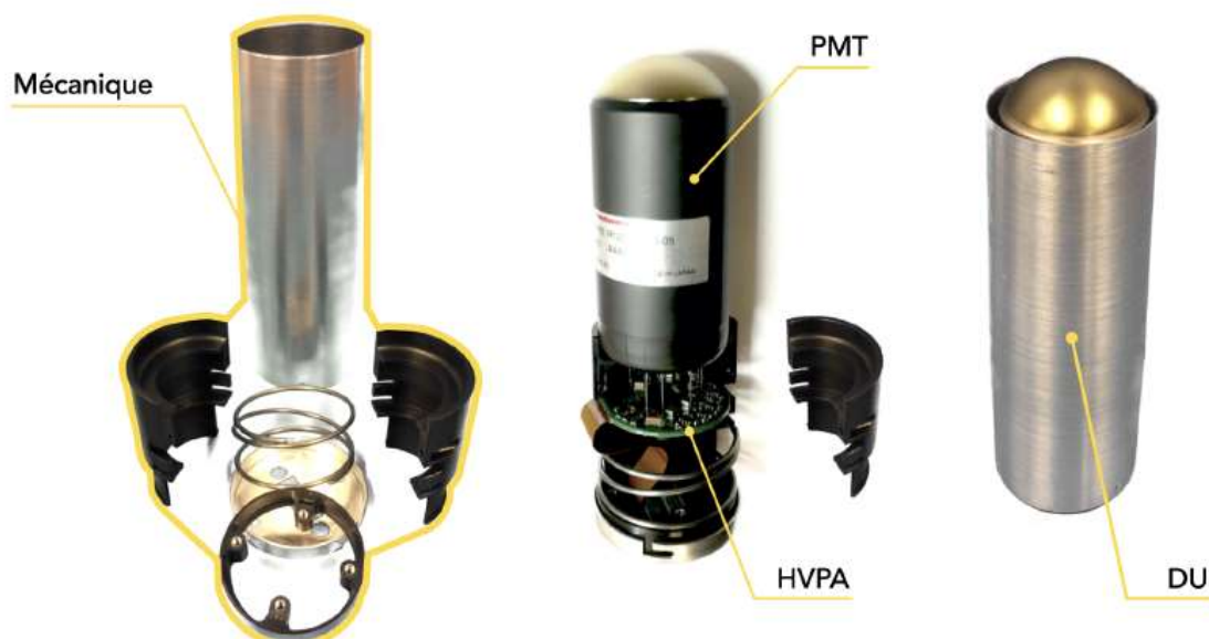
Figure 4 : Assemblage mécanique d'une précédente production de DU. A gauche les éléments mécaniques d'un DU, au centre montage de maintien de l'ensemble PMT-HVPA, à droite DU habillé dans son tube en aluminium. (image non contractuelle, des évolutions mineures sont prévues)
